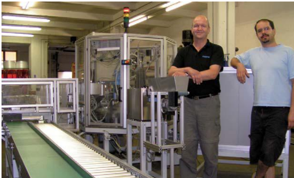
Ausgeklügelt: Alle 1,7 Sekunden baut diese Maschine aus fünf Einzelteilen ein fertiges Teil. Christian Steiner, MSK Kramsach (li.) mit Chef-Konstrukteur Christian Lederer, Fa. Schwehla.
